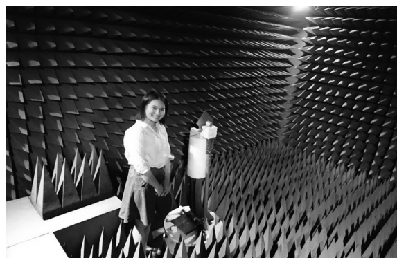
図6 電波暗室におけるメタ表面からの放射特性の特性
