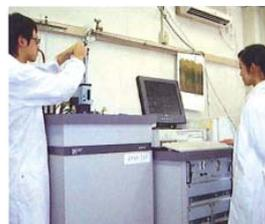
SQUID 磁束計による測定
