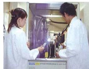
単結晶自動 X線解析装置による測定
