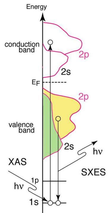
図6: 軟X線吸収、発光分光の原理
