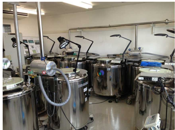
図4 貴重な深海バイオリソース が保管された液体窒素タンク
