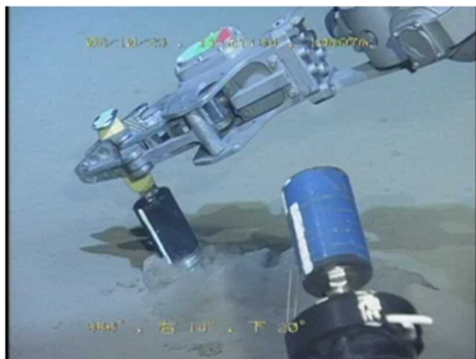
図3 深海底での堆積物採取の様子
