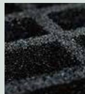
ゴム製品メーカーと共同研究したゴム製床材。ゴムの粒子を数ミリ単位でブロック状に固めた多孔質な構造により吸音。
