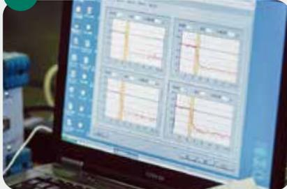
周波数ごとに残響時間(音の響き具合)を測定。「工学部研究資料館」の残響時間は約1.6秒でコンサートに最適。
