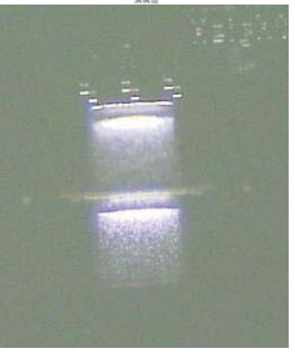
溝構造を斜めから撮った写真： 溝の壁側が湾曲しているのが確認できる。
