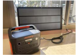
写真2：ソーラーパネルを用いた蓄電池への充電の様子
