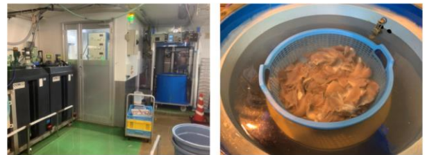
図2 アニサキス殺虫プロトタイプ機及び処理槽に魚身を入れた状態 工場に設置したアニサキス殺虫装置プロトタイプ機は、冷塩水生成装置、パルス電源、処理槽からなります。処理槽に魚身を入れて処理を行います。
