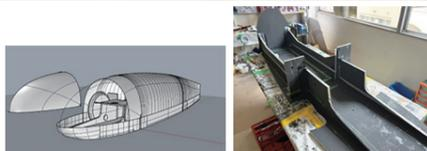
現在制作中の新車両の完成予想図と製作途中の様子です。カーボン製フレームによる軽量化に加えて空気抵抗の少ない流線形の形状にすることで更なる記録の更新を図っています
