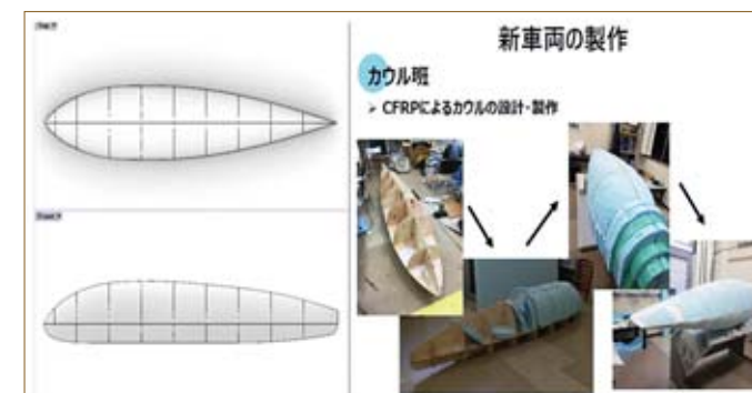
新車両の構想です。電池の消費を抑えるため、空気抵抗の少ない流線形の車両を設計しています。来年のレースまでの完成を目指します。
