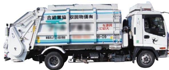
▲計量機付きごみ収集車(バックカー車)
