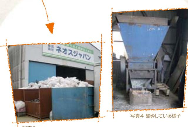
この集積したペットボトルは、佐賀県の業者(写真3)へ送られ、機械で小さく破碎され(写真4)、主に中国へ輸出され、私たちが日ごろ身につける服やバッグなどの化学繊維の原材料としてリサイクルされています。
