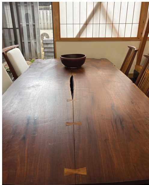
2枚の板を木の継ぎ手でつなぐ伝統的な手法は、家具にもみられる
