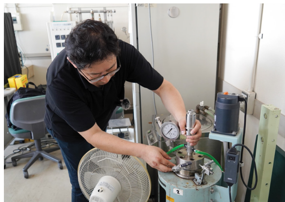
水と原料などを入れ、圧力をかけて摂氏300度ほどまで上げることができる「高圧リアクター」
