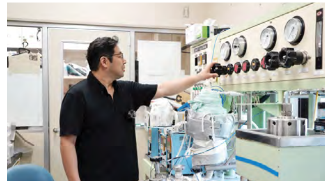
超臨界二酸化炭素を使って油や不純物などを抽出する超臨界CO 2 抽出装置
