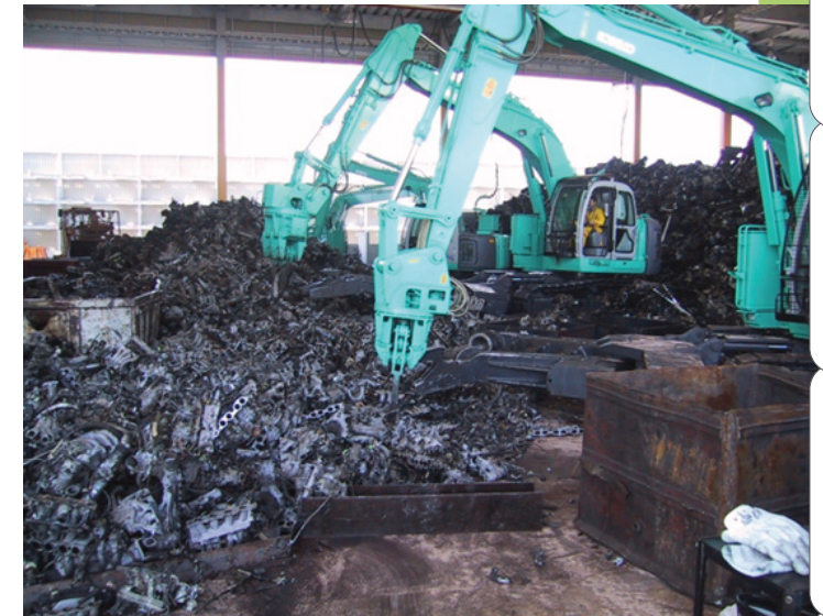
21世紀の自動車リサイクル技術革新のもう1つの要は自動車解体機(緑色の自動車解体用の重機)の開発である。この機械は現在日本人が経営する解体工場のほとんどで導入されている。非常に正確に銅や鉄を分解して取り外すことのできる機械である(2003年、富山エコタウンの自動車解体業者にて。外川撮影)。
