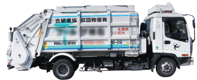
計量機付きごみ収集車▶ (パッカー車)
