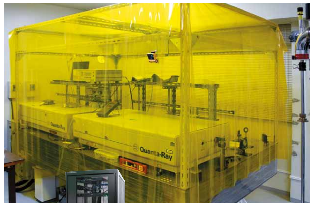
上/Nd:YAGパルスレーザーと、光パラメトリック発振レーザー 物質の光応答を調べる際の励起光として用います。紫外線、可視光、近赤外光の任意の波長で高強度の光パルスが得られ、様々な物質の光物性研究と、強励起効果の研究に用いています。
