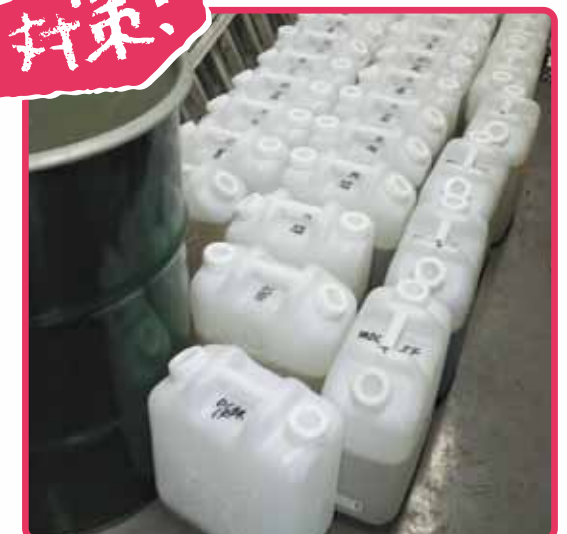
ポリ容器による漏水の回収
