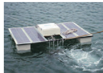
太陽電池と多流体混合装置によるマイクロバブルで水質浄化
