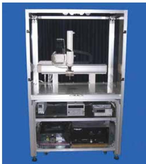
図 4-4 薄膜金属剥離装置
